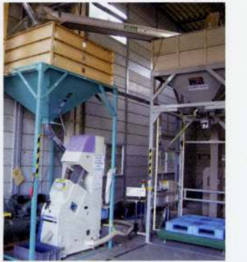
工程がスムーズに進むように色彩選別機、計量機それぞれに予備タンク(1t)が設けられています。
