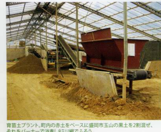
育苗土プラント。町内の赤土をベースに盛岡市玉山の黒土を2割混ぜ、それをバーナーで消毒し8ミリ網でふるう
